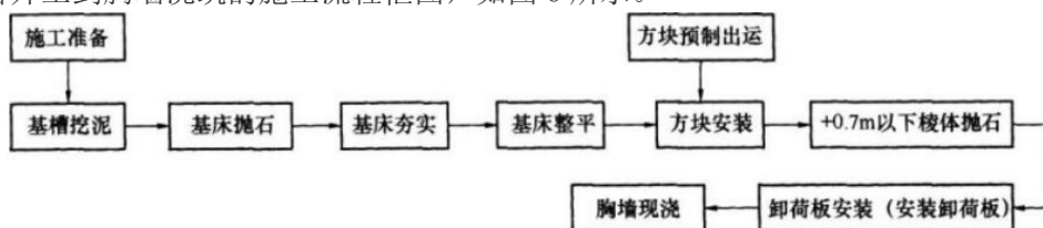
图 6 开工到胸墙浇筑的施工流程框图
